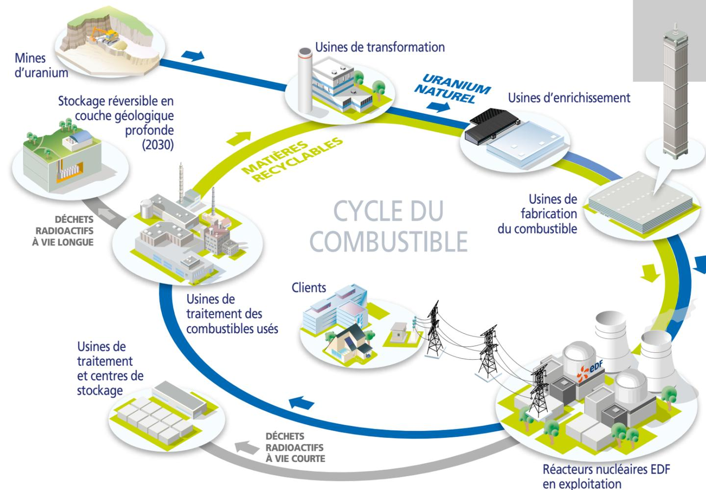
Le combustible nucléaire « usé » est traité et recyclé sous la forme d'un « mélange d'oxydes » (MOX), composé d'oxydes de plutonium. Le MOX réutilise les matières valorisables issues du traitement du combustible usé et à économiser les ressources d'uranium naturel.
