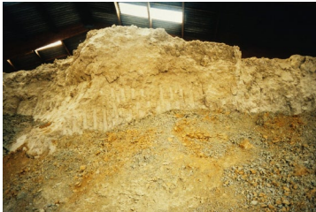
Chemises graphite des combustibles UNGG
